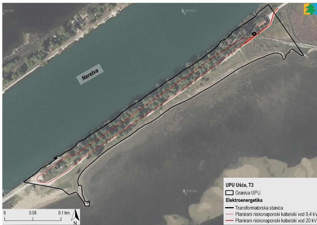
Slika 1.7 Elektroenergetski sustav unutar obuhvata Plana
