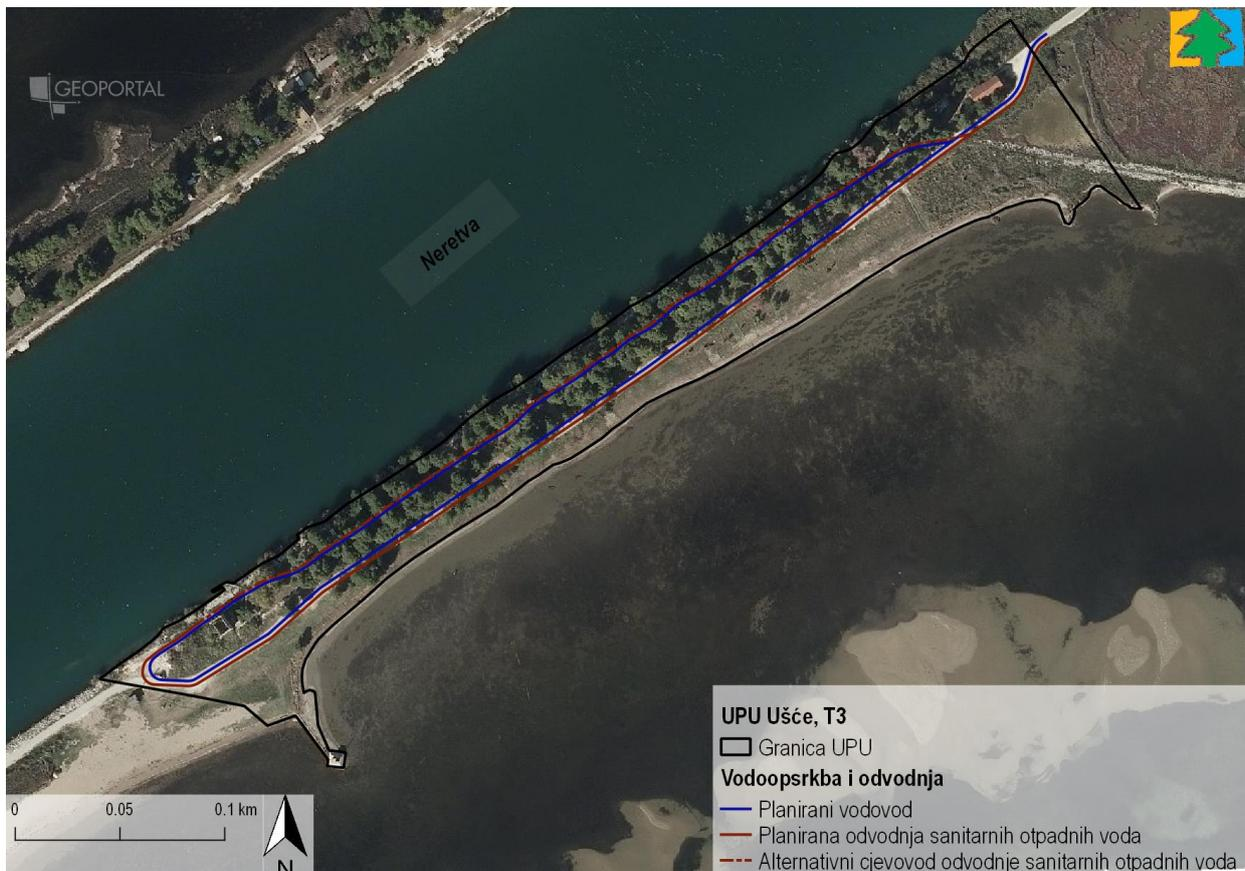
Slika 1.8 Planirana vodovodna cijev i kanali za odvodnju otpadnih voda unutar obuhvata Plana
