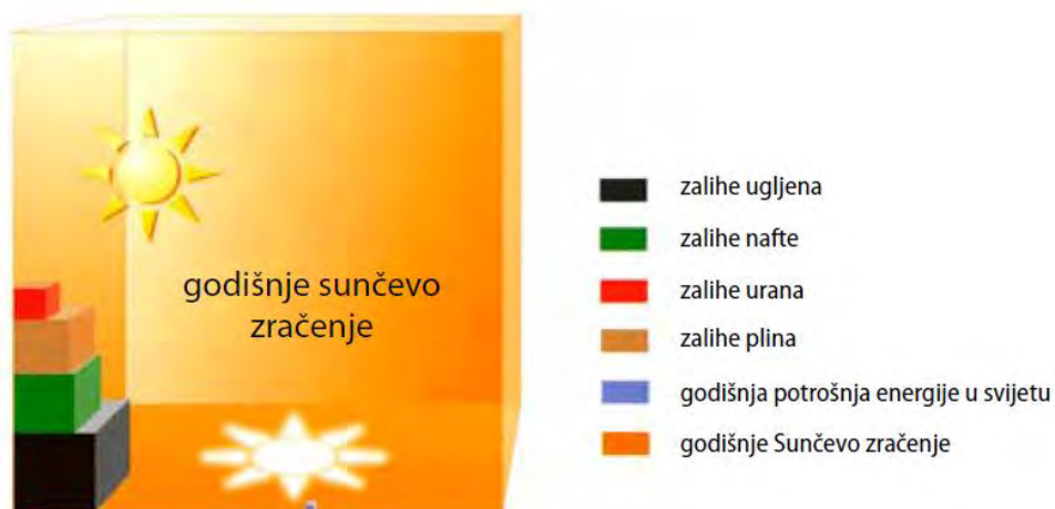
Slika 2.1.8. Godišnje sunčevo zračenje na površini zemlje u usporedbi sa zalihama fosilnih i nuklearnih goriva te godišnjom potrošnjom energije u svijetu, Izvor: Njemačka udruga za sunčevu energiju – Deutschen Gesellschaft für Sonnenenergie e.V
