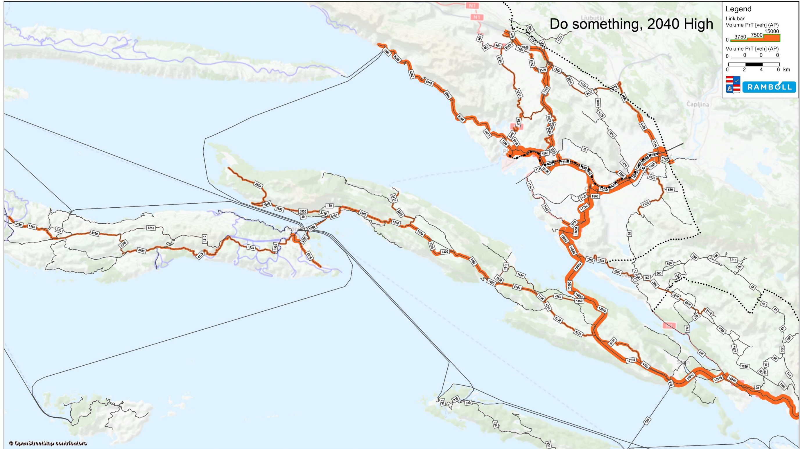
Slika 154. Prometna opterećenost u scenariju "Učini nešto" u sezoni 2040. g. - Sjeverni dio FRID
