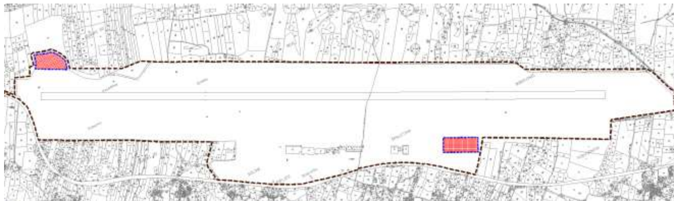
Prilog 144: Dvije zone planiranih privremenih pogona i postrojenja unutar obuhvata zahvata ( Idejni projekt rekonstrukcije postojećeg stanja Zračne luke Dubrovnik, Trames d.o.o.,- izdana lokacijska dozvola (Klasa: UP/I-350-05/13-01/138; Urbroj: 531-05-14-13, Zagreb, 09. travnja 2014.) )
