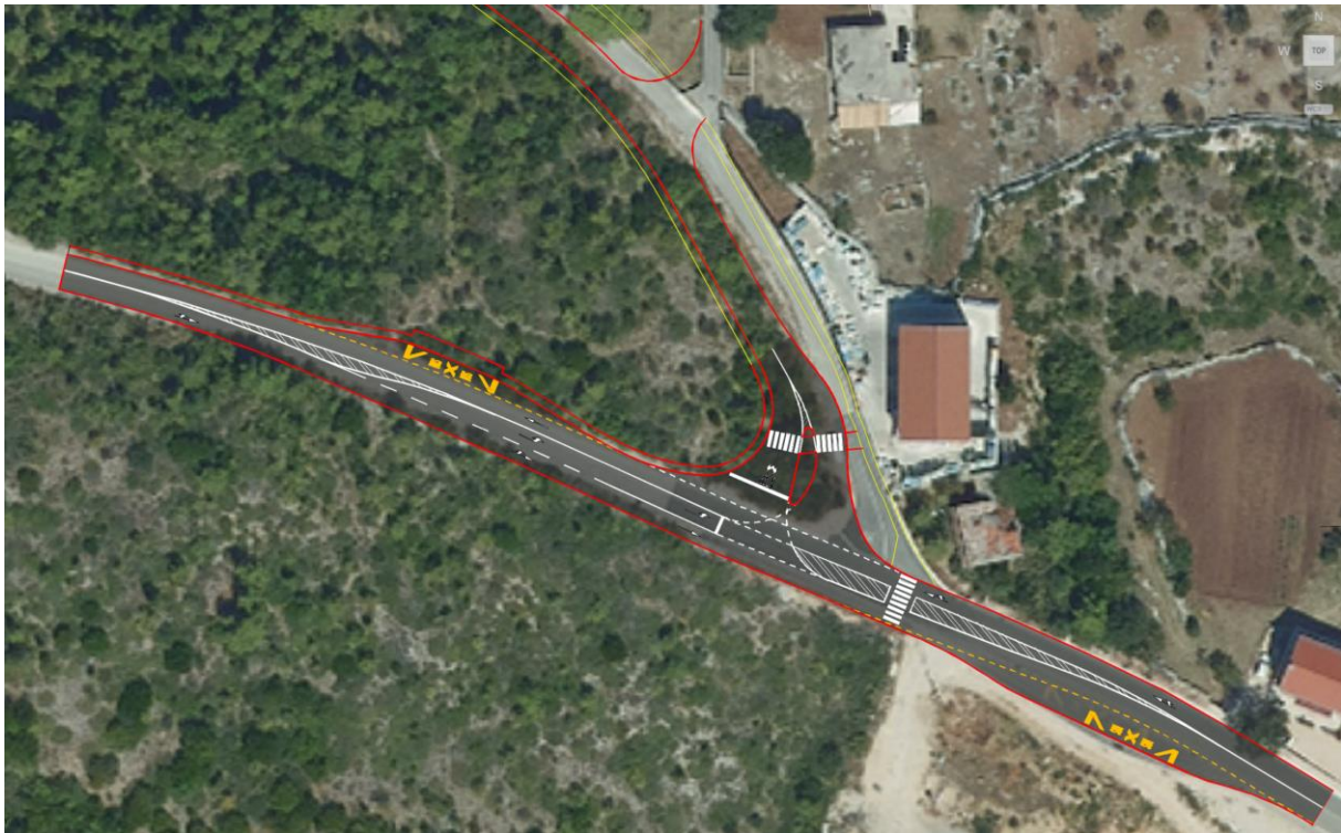
Slika 43: Prijedlog rješenja križanja nerazvrstane ceste za Osojnik s planiranom glavnom prometnicom (jug)
