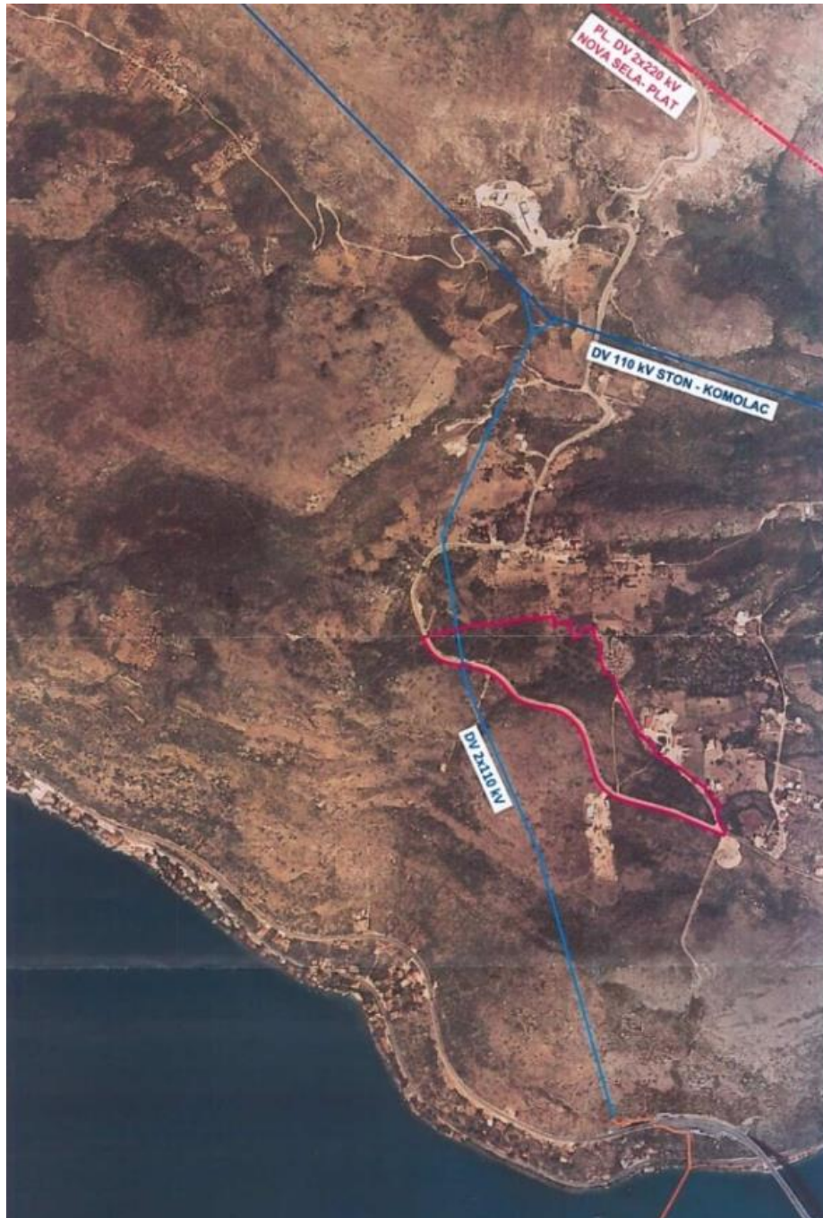
Slika 35: Postojeći i planirani dalekovodi
